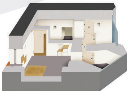
Rysunek ilustruje wygląd dwusektorowego schronu bojowego B.18 i jego położenie w zarysie kamienicy; autor: Krzysztof Kucharski
